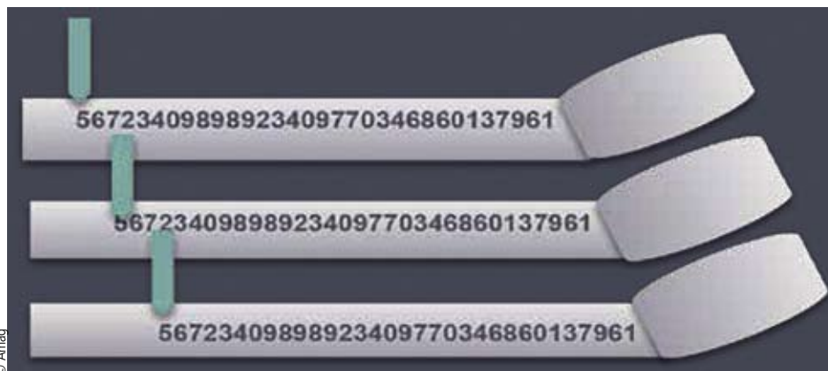
Abb. 2: An der Längsteilschere werden die einzelnen Abschnitte neu mit den Zahlenfolgen bedruckt
